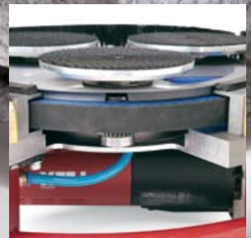
Aandrijving door een tandriem.
