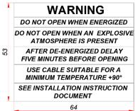
natpisnom pločicom na kućištu, tip PLFM 70 HSE-3:
