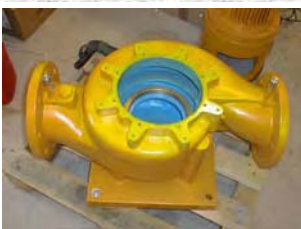
Siège de pompe enduit
