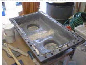
Capot de protection corrodé
