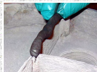
Kanten können mit Putty einfach wiederhergestellt werden
